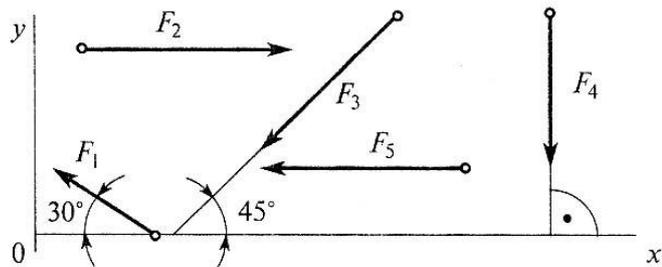
19. Составлено уравнение для расчета реакции в опоре А. Какого слагаемого в уравнении  $\sum F_{kx} = -R_{Ax} + 25 \cdot \cos 45^\circ \dots = 0$  не хватает?
