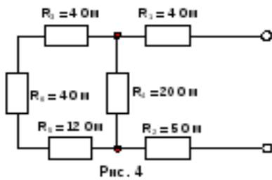
1. Найдите общее сопротивление, если  $R_1 = 4 \text{ Ом}$ ;  $R_2 = 5 \text{ Ом}$ ;  $R_3 = 4 \text{ Ом}$ ;  $R_4 = 20 \text{ Ом}$ ;  $R_5 = 12 \text{ Ом}$ ;  $R_6 = 4 \text{ Ом}$
